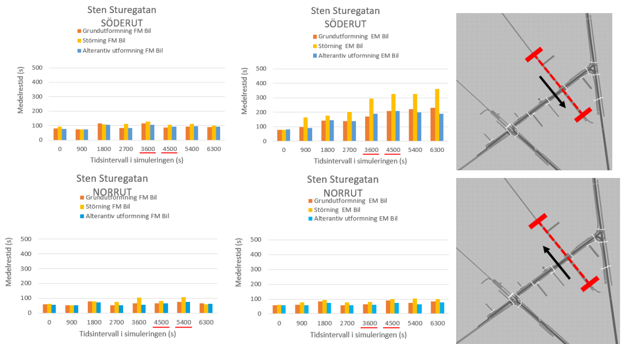
Figur 26 – Restider längs Sten Sturegatan. Tidsintervall som är understruken motsvarar tidsperioder då störning föreligger för de två störningsscenarioerna. Störningen föreligger 3000–4500 sekunder in i körningen och det finns en viss fördröjning innan spårvagnarna når korsningspunkterna.
